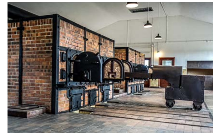
Die Erfurter Firma "Topf & Söhne" entwickelte im Auftrag der SS spezielle Krematoriumsöfen nach dem Vorbild von Müllverbrennungsanlagen. "Topf & Söhne" lieferte später auch zehn Öfen nach Auschwitz. Dort schafften diese Öfen am Tag bis 3.000 Leichen zu verbrennen. Heute befindet sich in dem Betriebsgebäude von "Topf & Söhne" in Erfurt eine Gedenkstätte.
